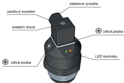
obr. 6: Popis hlavních částí snímače
