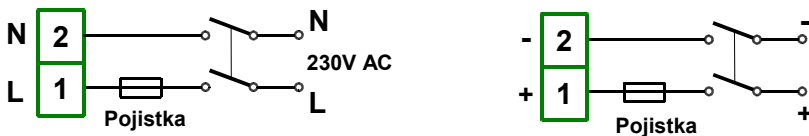
Obrázek 4.3 Schéma připojení napájecího napětí a pojistky
